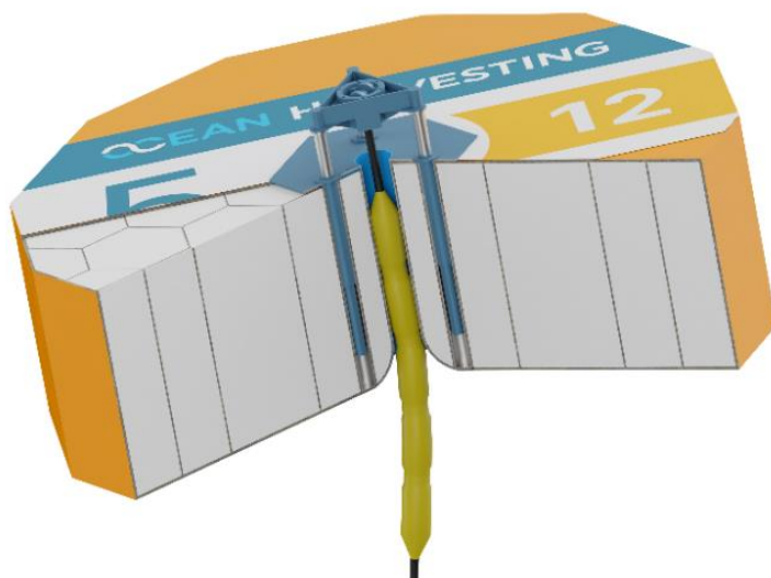
Ocean Harvestings boj med tunnväggig bikakestruktur av höghållfast betong och EPS kärnor.
